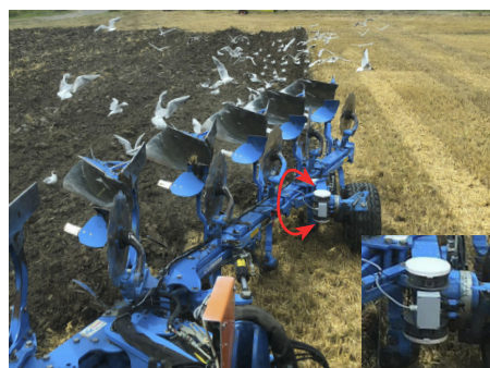
▲ SmartPLOUGH OnLand met dubbele RTK ontvanger
