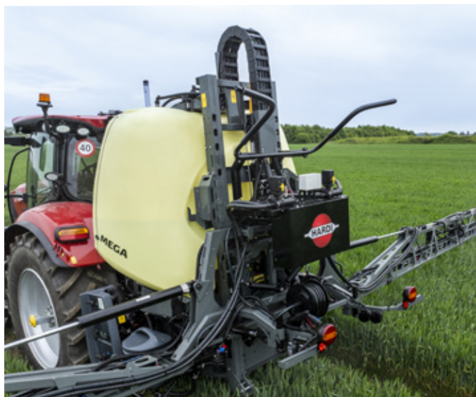
Lange spuitboomhefinrichting, voor een groot bereik aan werkhogtes van 50-210 cm.
