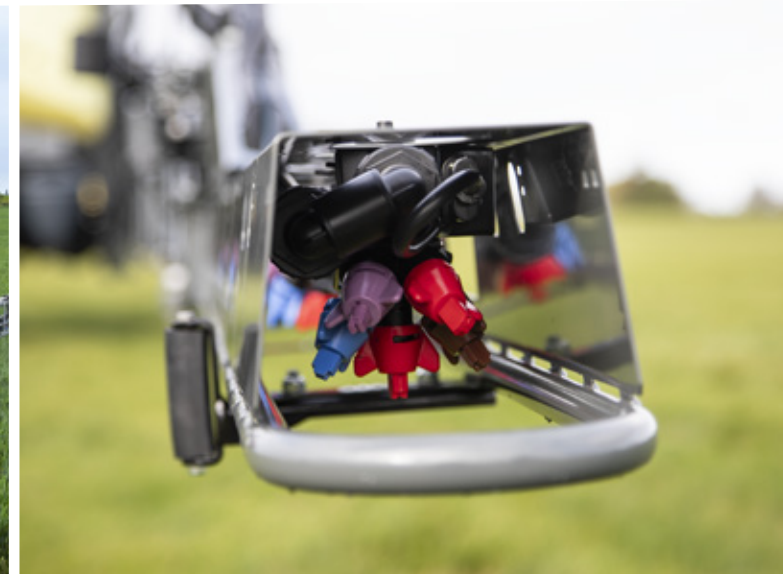
Spuitdoppen zijn beschermd voor een lagere spuitboomhoogte en betere driftbeheersing.
