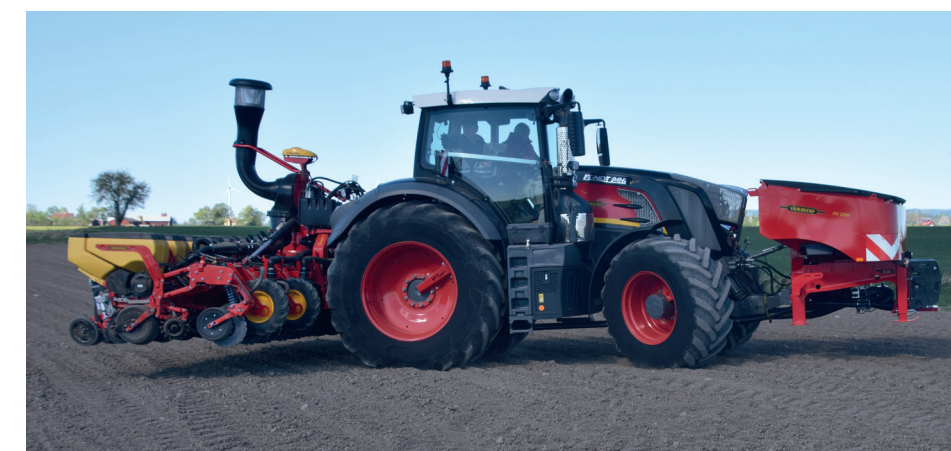
De tempo V 6-12 is nu een hele cleane machine doordat aanvoerslangen mooi zijn weggewerkt onder de trekker.
