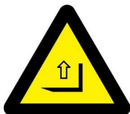
Figure 3 - Point de prise du chariot élévateur
