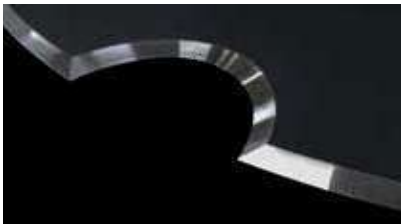
Väderstad TrueCut is een unieke methode voor het frezen van de uitsparingen in de schijven. Het zorgt voor een perfect gelijkmatige slijtage van de schijfdiameter waardoor de oorspronkelijke schijfvorm behouden blijft.
