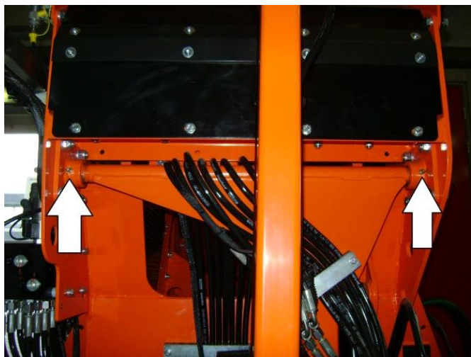
61N. Schmiernippel Zylinder und Gelenkpunkte 3
