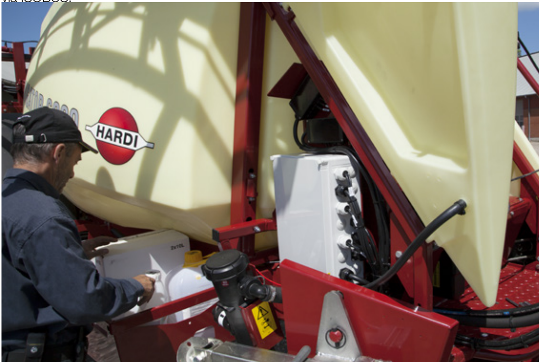
HARDI ECU met ISOBUS-brug en JobCom.
