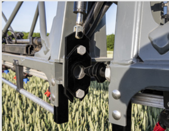
Een stop-en-vergrendelingsysteem voorkomt speling tussen de boomdelen, die soepel in- en uitgeklapt worden met SoftOpen/SoftClose cilinders.
