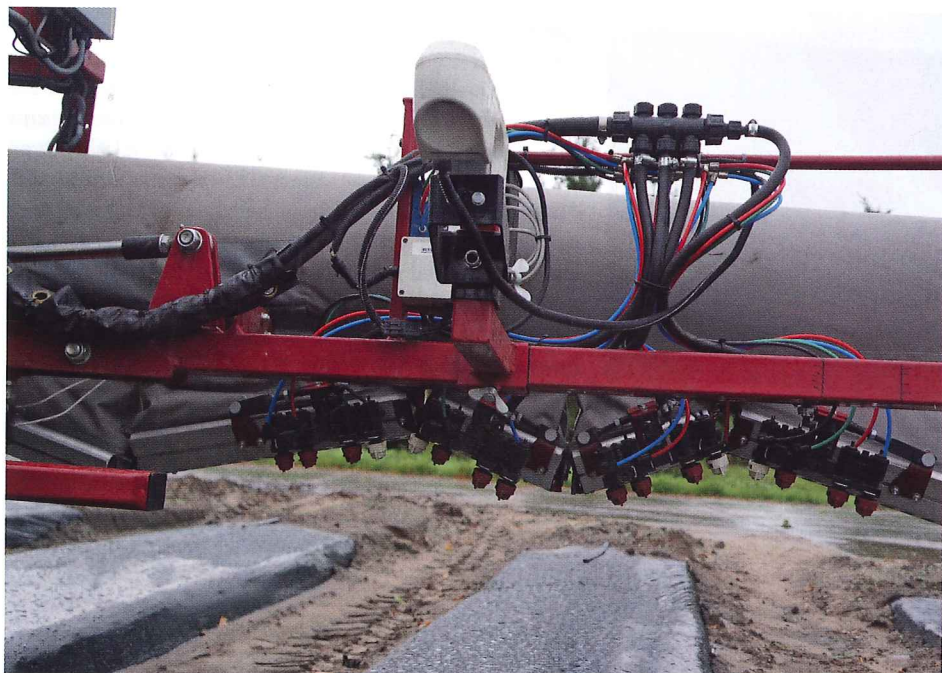
Plaatsspecifiek spuiten per bed met twee gewasrijen. Dat gaat per rij met 2 sets clusterdoppen met gewasafhankelijke afgifte, en 2 gerichte ondersteunende luchtstromen. De sensor hangt midden voor.
