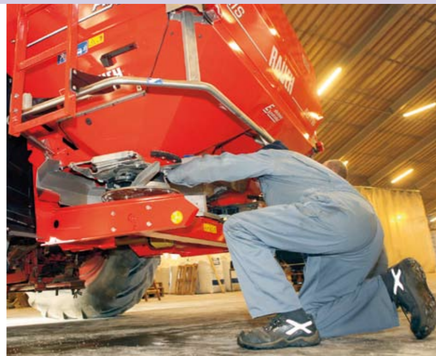
Elke strooier wordt door het testteam afgesteld volgens de handleiding, dus juiste hoogte en juiste hellingshoek.
