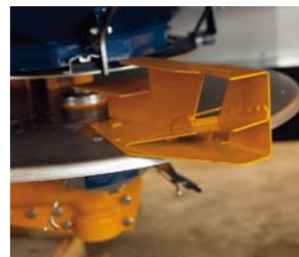
De strooischijven draaien bij Bogballe van buiten naar binnen. Bij kantstrooien draait de draairichting van de schoepen om.
