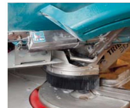
De rechter strooi-schijf heeft naast twee gewone strooi-schoepen ook een kort gebogen kantstrooi-schoepje.
