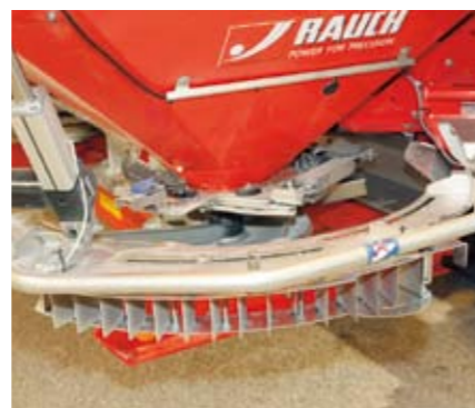
Kantstrooien wordt via de computer geactiveerd. De kantstrooi-inrichting (Telimat) klapt dan elektrisch naar beneden.
