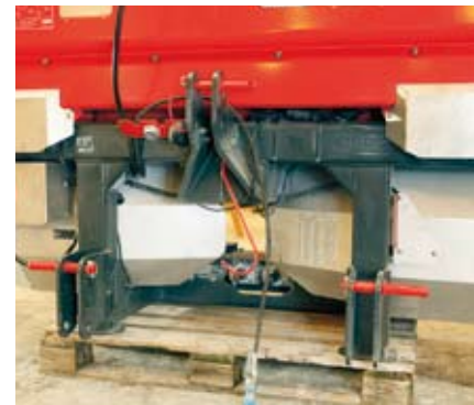
De Vicon heeft het meest vernuftige weegstelsel met vier weegcellen en een sensor die hellingen en schokken corrigeert.
