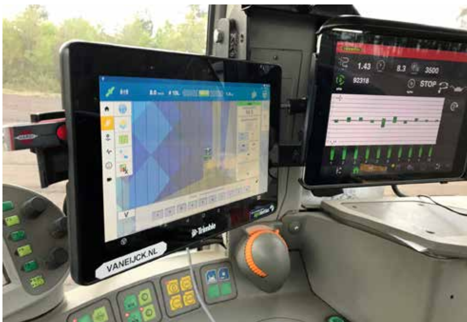
Taakkaarten in Trimble communiceren met de Väderstad-terminal zodat de Tempo de secties variabel afsluit.
