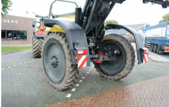
Door het ComfortTrack-systeem sturen de spatborden mee met het rijden.
