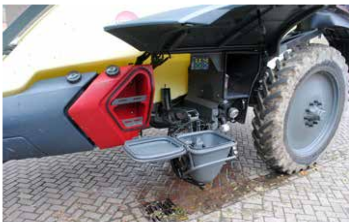
De tank is aan de linkerkant uitgevoerd met een fustreiniger en een afvoerkoppeling voor de toepassing van vloeibare kunstmest.
