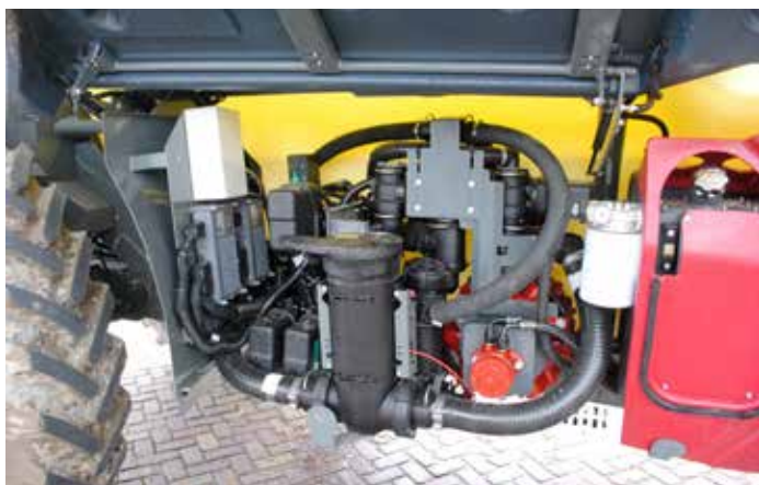
Zuig- en persfilter zijn bij elkaar onder een klep aan de rechterkant van de machine gesitueerd.
